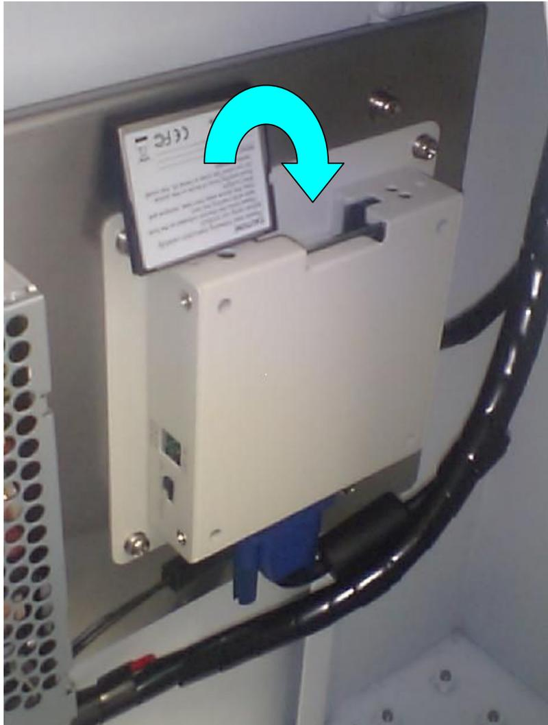
左写真のように、CFの裏面を手前に向けてメディアプレイヤーに挿入してください。最後まで指で押し込むようにお願いします。
